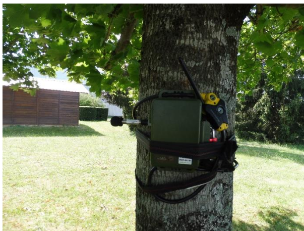
Photo 7 : Pose d'un SM4 sur les emprises du site (©IEA)
